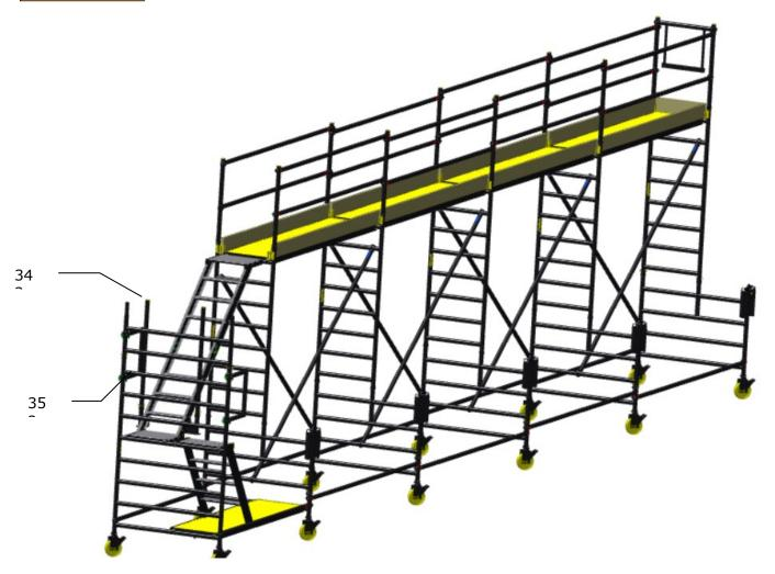
34: montieren Sie die Geländerpfosten an die Treppe und stecken Sie die Federstecker in den Löchern
