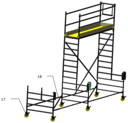
17: stecken Sie beide Räder in den Rahmen; sorgen Sie dafür das die Räder gut gesichert sind. 18: montieren Sie die Horizontalen und die Horizontal-Diagonale.
