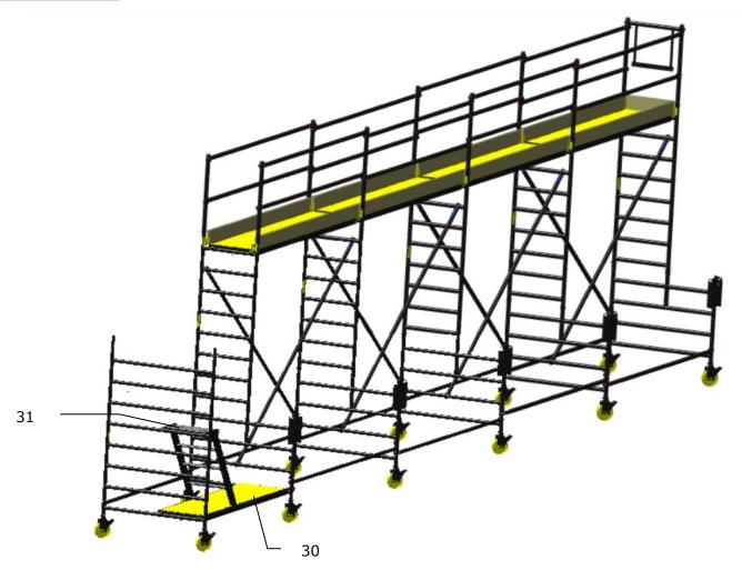
30: montieren Sie das Plattform und schieben Sie die beide Windsicherungen unter die Sprosse 31: montieren Sie die kleine Treppe
