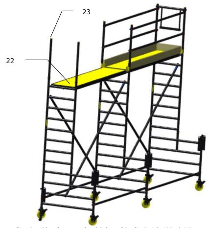
22: montieren Sie das Plattform und schieben Sie die beide Windsicherungen unter die Sprosse23: montieren Sie die Geländerständer und stecken Sie die Federstecker in den Löchern zwischen Geländerständer und Rahmen
