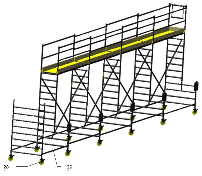
28: stecken Sie beide Räder in den 8-Sprossenrahmen; sorgen Sie dafür das die Räder gut gesichert sind.
